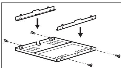
Ako koristite zaštitnu kutiju (dodatni pribor<sup>1)</sup>), prednji prostor za protok zraka od 5 mm i zaštitni pod direktno ispod uređaja nisu neophodni. Zaštitnu kutiju ne možete koristiti ako uređaj postavite iznad pećnice.
