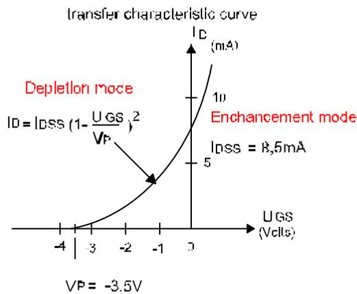
Gambar 2.152 Kurva Transkonduktansi  $I_D - U_{GS}$
