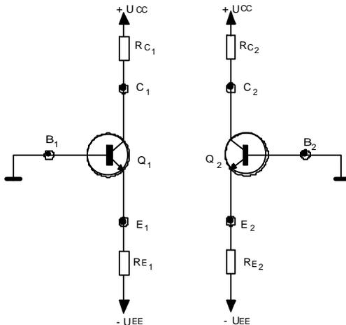
Gambar 2.197 Dua Rangkaian "Emiter-biased" yang identik 0
