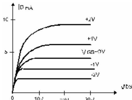
Gambar 2.156(a) Karakteristik Output D Mosfet Cahanal N
