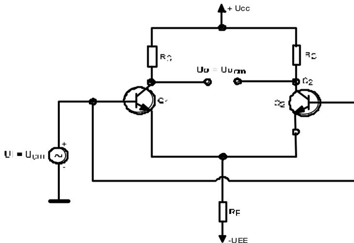
Gambar 2.203 Penguat diferensial pada konfigurasi *common mode*
