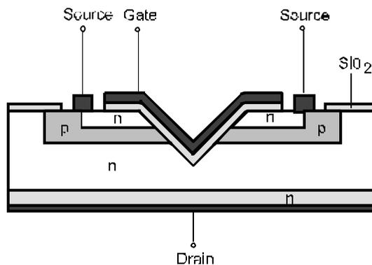
Gambar 2.168 Susunan Bahan V Mosfet Enhancemen Kanal N
