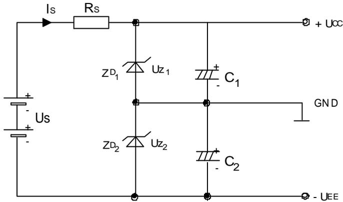
Gambar 2.194 Sistem Sambungan Seri Dari Dua Buah Zener
