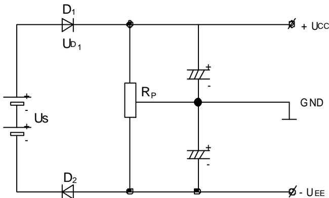
Gambar 2.195 Sistem Dua Buah Diode dan Potensioener
