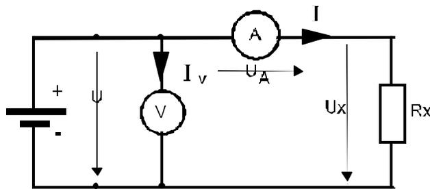
Gambar 2.48 Kesalahan Pengukuran Tegangan
