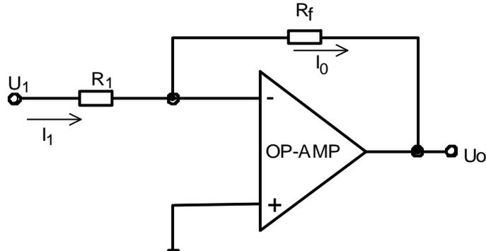
Gambar 2.237a Rangkaian Tegangan Mengontrol Arus Sumber
