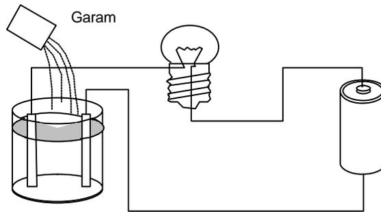
Gambar 2.5 Percobaan Penghantar Arus dalam Zat Cair
