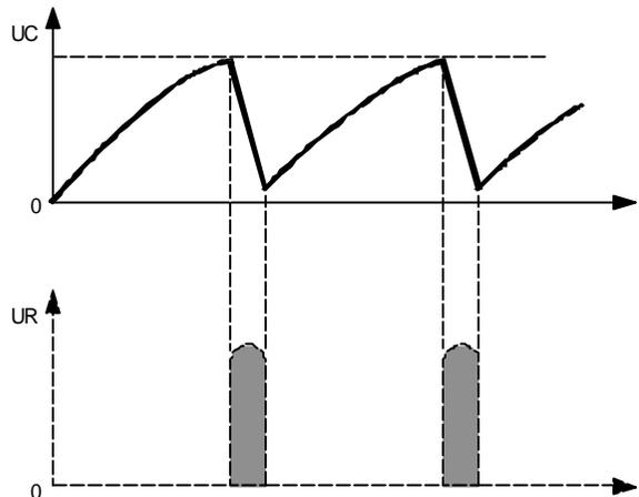
Gambar 2.182 Denyut tegangan selama C membuang muatan
