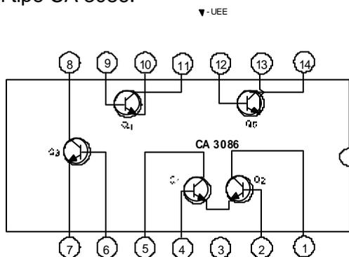
**Gambar 2.215** Diagram Fungsi IC tipe CA 3086
