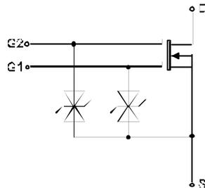
Gambar 2.167 Rangkaian Pengganti Mosfet Dua Gerbang Type BF 961
