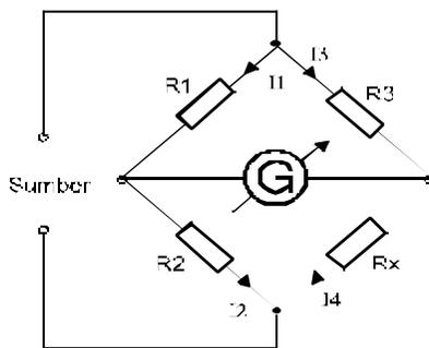
$$I_1 \cdot R_1 = I_2 \cdot R_2 \dots\dots\dots I$$
