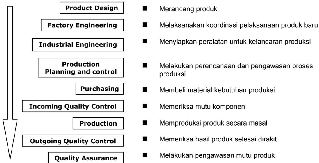
**Gambar 2. Lifecycle Proses Pembuatan Sistem Elektronika.**
