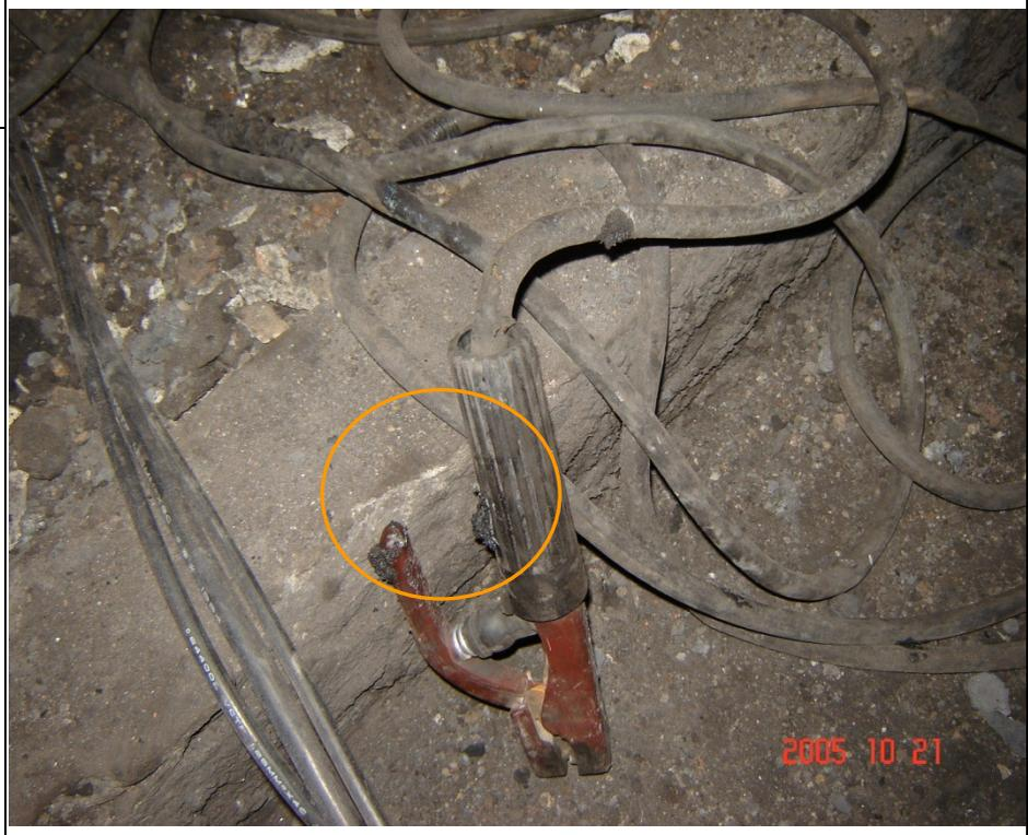
1-2 Cara isolasi dari mesin las yang benar
