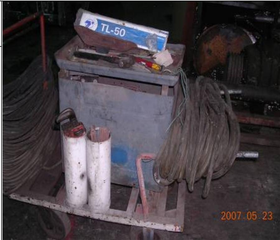
1-4 Mesin las yang terpasang alat anti sengat listrik model gantung
