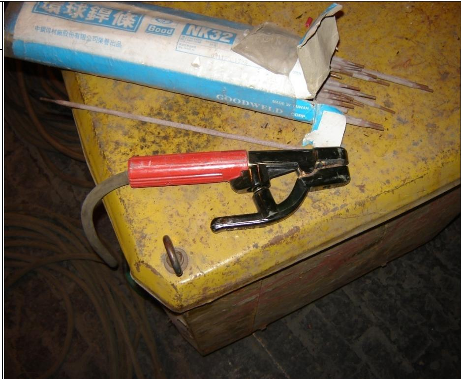
1-3 Mesin las yang tidak terpasang alat anti sengat listrik)
