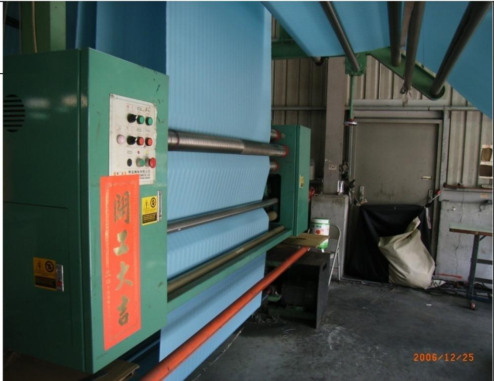
2-4 Kotak pelindung bagian mesin yang berputar yang benar 2
