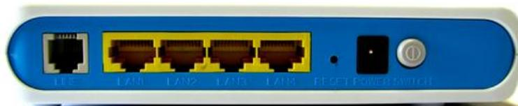
**4.1.** Соедините **Line**-порт (LAN1-4 для многопортовых моделей) QDSL-1000 (1) и **Modem**-порт сплиттера (3) при помощи кабеля (2). **Phone**-порт сплиттера предназначен для подключения телефона, а **Line**-порт сплиттера должен быть соединён с телефонной линией.
