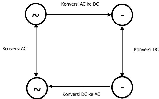
Gambar 8. Konversi parameter listrik dalam elektronika daya
