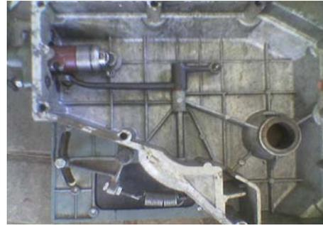
Camshaft Gear berfungsi untuk mengatur proses pembukaan dan penutupan katup in dan katup ex. Camshaft berhubungan langsung dengan Governor Gear. Putaran Governor Gear akan memutar Camshaft Gear. Dari putaran tersebut, Camshaft gear juga akan ikut berputar sehingga cam pada poros nok akan ikut berputar dan menekan lifter yang selanjutnya dari lifter dilanjutkan ke push rod dan push rod menekan rocker arm dan menekan ujung batang
