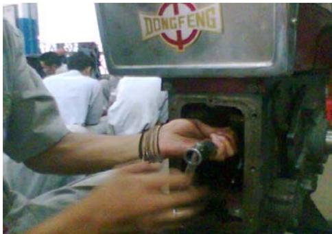
Gambar 4. Melepas baut *connecting rod* pada poros engkol
