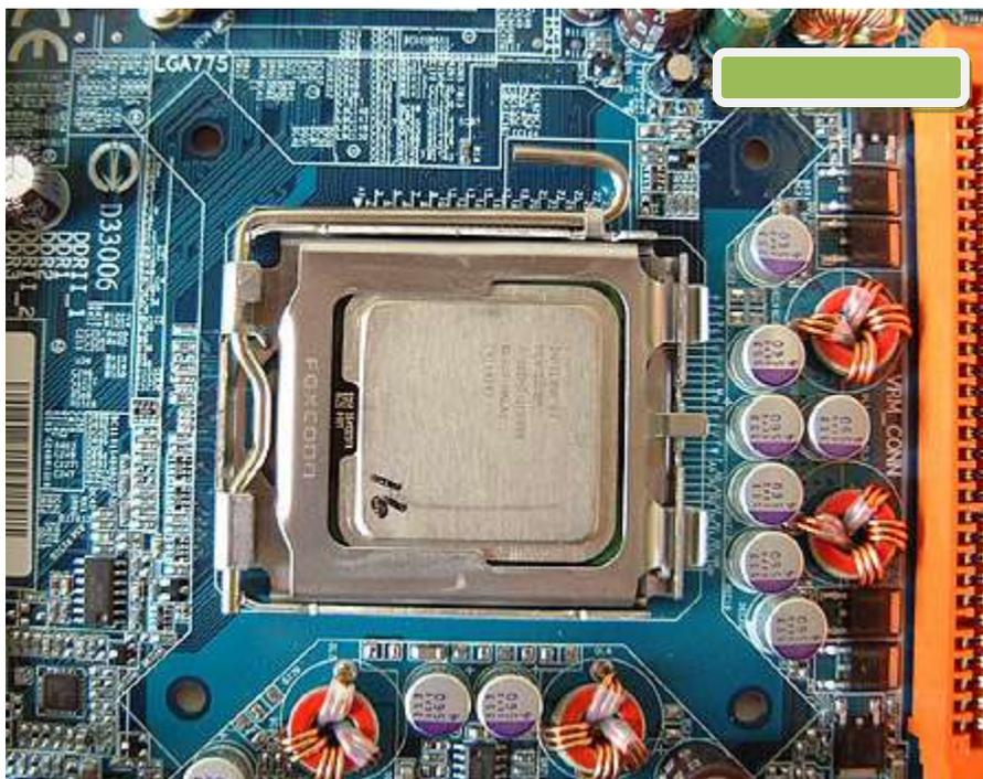
Sekarang waktunya untuk memasang heatsink atau aluminium pendingin. Perhatikan lubang pengaman untuk heatsink seperti gambar di bawah ini;
