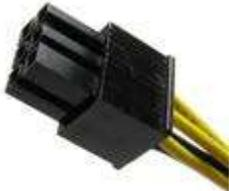
The power 6 pin ATX konektor catu daya motherboard merupakan konektor yang digunakan untuk memberikan 12 VDC ke regulator tegangan prosesor tetapi dalam banyak kasus, 4-pin konektor lebih sering digunakan. Konektor kecil ini biasanya melekat pada motherboard dekat CPU.
