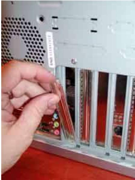
Silakan buka PC Card Slot Cover seperti gambar diatas. VGA card yang akan dipasang tergantung yang disediakan. Ada VGA yang menggunakan slot PCI (slot warna putih) dan ada yang menggunakan slot AGP (slot warna coklat).
