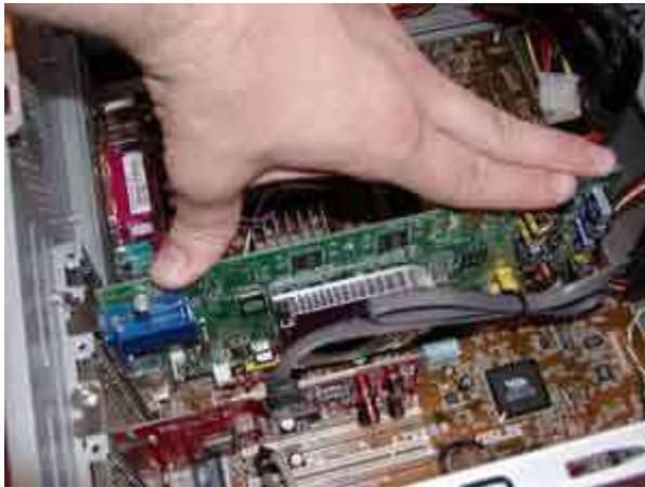
Dalam contoh ini saya menggunakan gambar VGA Card yang menggunakan slot AGP. Setelah terpasang silahkan dikunci dengan sekrup pada bagian belakang casing komputer.
