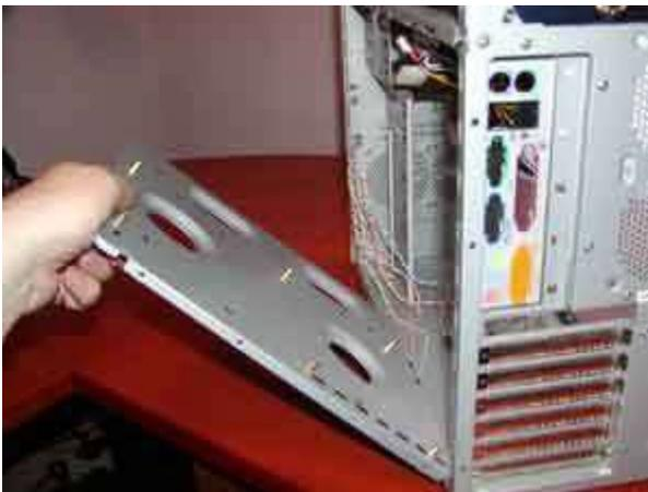
Ini sifatnya optional untuk membuka penutup utama casing. Mengapa disebut penutup utama karena pada penutup inilah nantinya akan dipasang motherboard. Jika Anda merasa nyaman memasang Motherboard langsung pada casing tanpa membuka penutup utama ini, itu tidak masalah.
