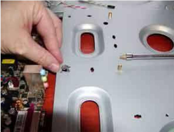
Sebagaimana disebutkan diatas bahwa sekrup harus dipasang pada tempat tepat sebagai standoff bagi Motherboard agar tidak goyang. Setelah memasang standoff secara tepat, kini saatnya memasang Motherboard dengan hati-hati hingga semua standoff menemukan lubang yang tepat pada Motherboard.
