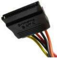
SATA 15 pin konektor catu daya adalah salah satu dari beberapa konektor daya standar perifer. Konektor power SATA hanya terhubung ke drive SATA seperti hard drive dan drive optik. Konektor daya SATA tidak bekerja dengan perangkat PATA atau ATA.
