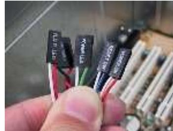
Kabel ATX Control biasanya include pada pembelian casing. Kabel kecil ini terdiri dari beberapa fungsi yaitu kabel power, hard drive LED, reset, dan kabel speaker connectors. Baca dengan seksama buku manual Motherboard karena penempatan kabel kecil ini ada pada buku manual Motherboard.
