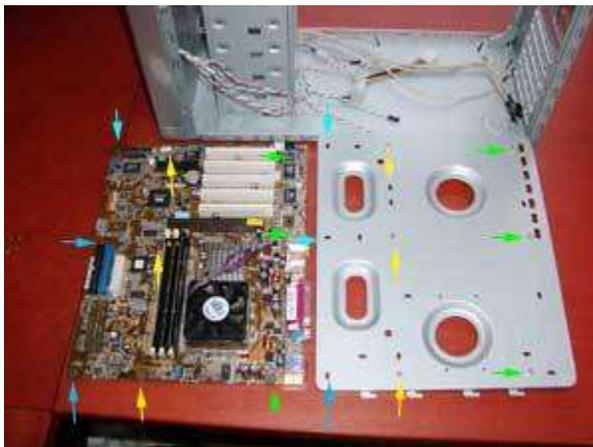
Ada berbagai ukuran motherboard desktop dan harus disesuaikan dengan casing, ada serangkaian lubang mounting yang perlu dicari dimana Anda akan memasang sekrup sebagai landasan memasang motherboard. Penempatan sekrup ini harus Anda sesuaikan dengan lubangnya pada Motherboard. Lihat gambar diatas.
