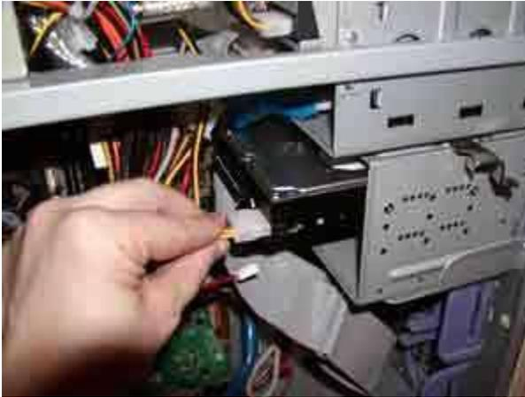
Selanjutnya pasang kabel power hard disk dari power suply ke hard disk seperti gambar di atas.
