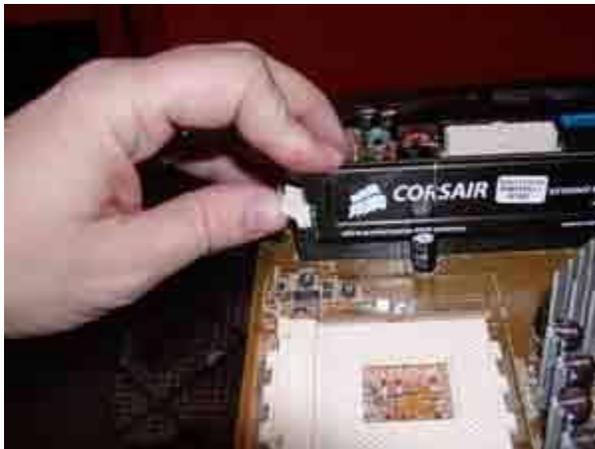
CATATAN; Dengan selesainya proses pemasangan memory diatas maka selesailah pemasangan perangkat keras pada tempatnya. Sekarang saatnya untuk memasang kabel kabel penghubung dengan Motherboard dan lain-lain.
