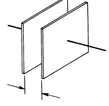
CAPACITANCE VARIES INVERSELY WITH THE DISTANCE BETWEEN PLATE SURFACES
