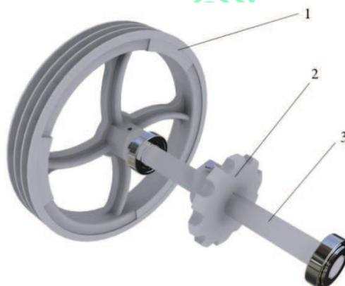
**Рис.5 Вал оголовника верхний транспортера загрузочного.**
