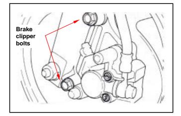
Remove brake lining bolt.
