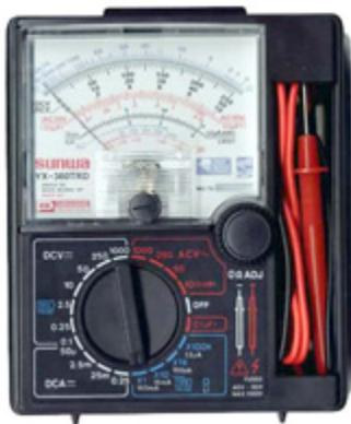
Gambar 4. Sebuah multimeter atau AVO meter adalah alat yang sekaligus dapat dipakai untuk mengukur kuat arus listrik (sebagai amperemeter), beda potensial listrik (sebagai volt meter), maupun hambatan listrik (sebagai ohm meter).
