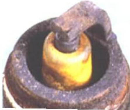
Isolator dan elektroda berwarna kuning atau coklat tua. Penyebab bensin dengan kandungan timah hitam tinggi. Gantilah busi dengan yang baru perhatikan spesifikasi pada buku manual / katalog busi
