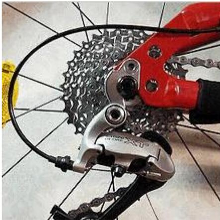
**Gambar 7.2: sprocket bertingkat pada sepeda**
