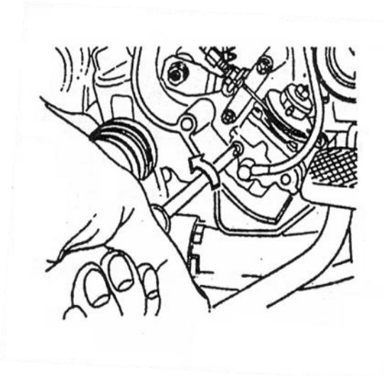
**Gambar 3.29: pengerasan baut penyetel pompa oli**
