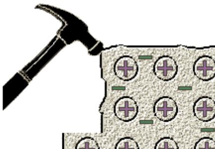
**Gambar 4.4** Ion positif tersebar dalam lautan elektron pada logam
