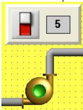
**3.5.** На экране, рядом с изображением насоса, создать панель с ГЭ типа **Выключатель** и с ГЭ типа **Текст**.
