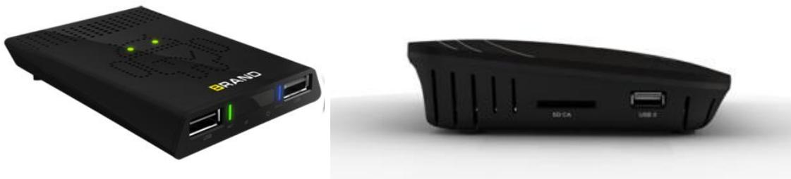
2. Вставляем подготовленную при помощи программы **PhoenixCard** карту SD/MMC с новой версией программного обеспечения в соответствующий слот для карт мультимедийной приставки **SN981A** или комбинированной DVB-S2/Android приставки **SD99010A**.
