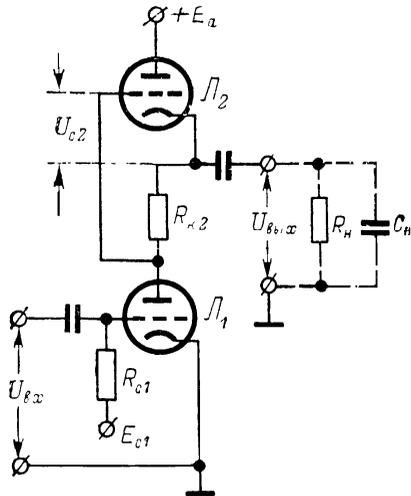
Рис. 39. Схема усилителя с динамической анодной нагрузкой.
