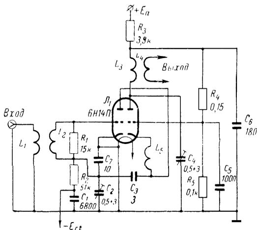
Рис. 21. Схема каскадного усилителя высокой частоты телевизионного приемника.
