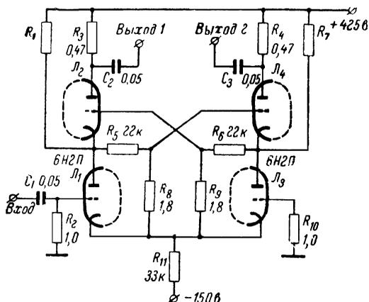
Рис. 34. Самобалансирующий фазоинвертор с перекрестными связями.
