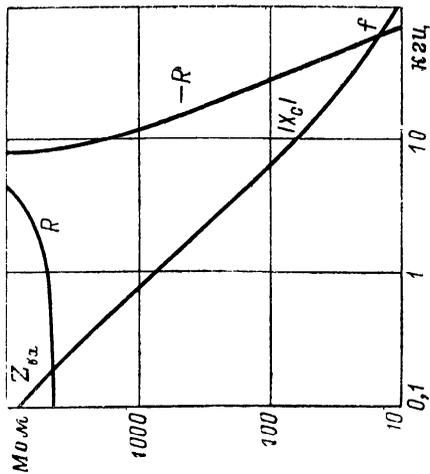
Рис. 77. Зависимость составляющих полного входного сопротивления  $Z_{вх}$  компенсированного катодного повторителя от частоты  $f$ .
