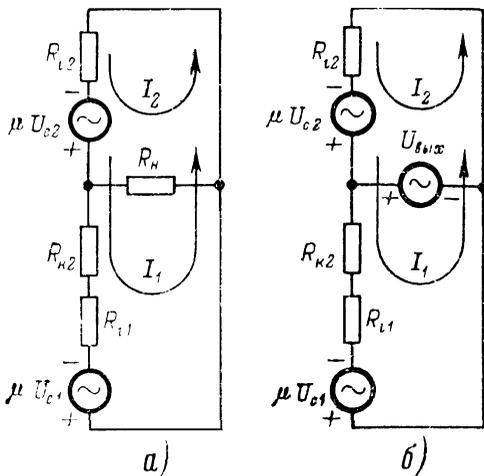
Рис. 40. Эквивалентные схемы усилителя.
