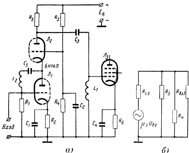
Рис. 6. Резонансный каскодный усилитель.
