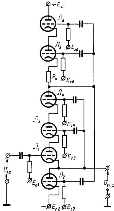
Рис. 80. Схема компенсированного катодного повторителя  $n$ -го порядка.
