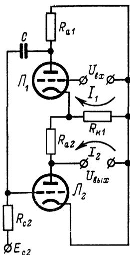
Рис. 66. Упрощенная схема каскодного повторителя с усилением.
