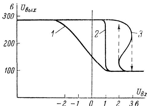
Рис. 33. Выходные характеристики интегрирующего усилителя.
