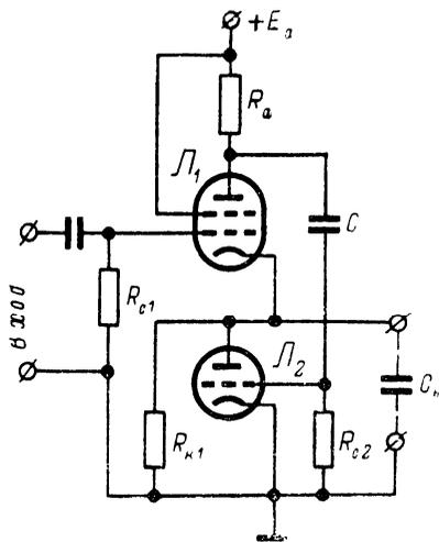
Рис. 64. Схема видеоизмененного импульсного катодного повторителя.
