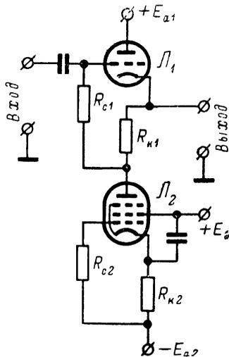
Рис. 46. Схема линейного катодного повторителя.
