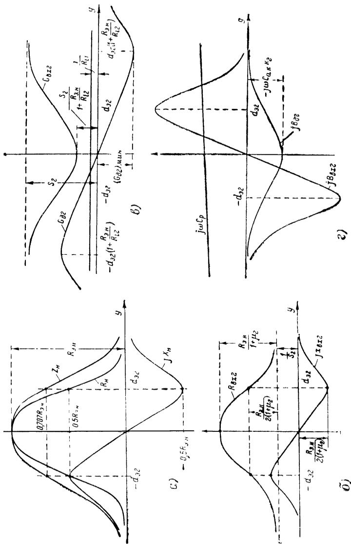
Рис. 5. Зависимость сопротивлений и проводимостей различных цепей каскадного усилителя от расстройки выходного контура.
