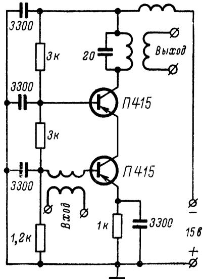
Рис. 20. Схема каскодного усилителя на транзисторах.
