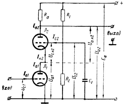
Рис. 1. Основная схема каскодного усилителя.
