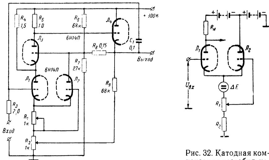
Рис. 31. Схема интегрирующего усилителя.
