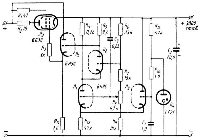
Рис. 29. Улучшенная схема электронного стабилизатора напряжения.
