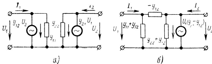
Рис. 17. Схемы замещения транзистора.
