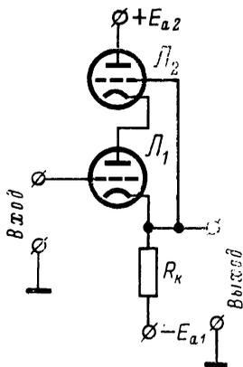
Рис. 73. Принцип анодной компенсации катодного повторителя.
