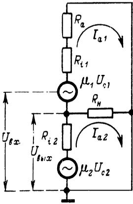
Рис. 50. Эквивалентная схема каскадного катодного повторителя.
