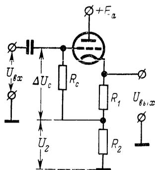
Рис. 45. Схема катодного повторителя.
