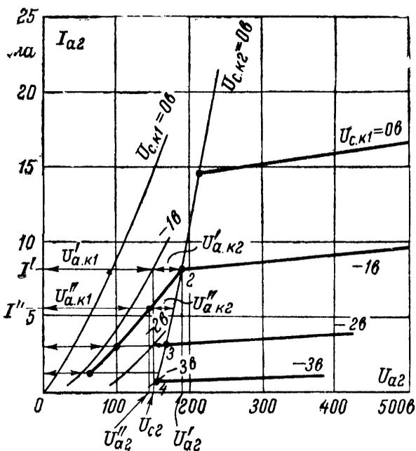
Рис. 9. Построение статических характеристик каскодного усилителя для области с точных токов.
