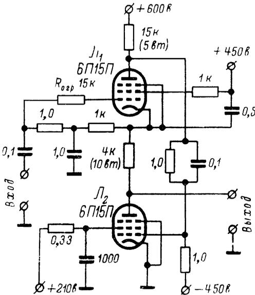
Рис. 68. Простая схема каскодного повторителя с усилением.
