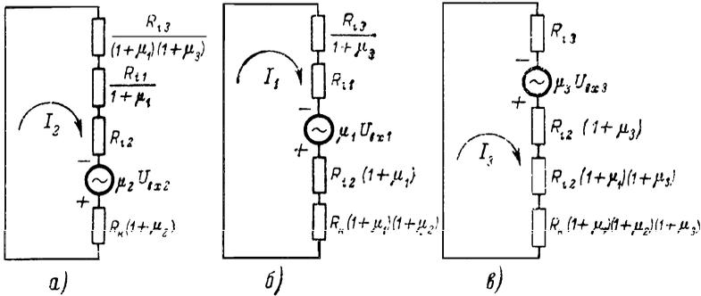
Рис. 75. Эквивалентные схемы для анализа компенсированного каскодного катодного повторителя.
