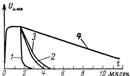
Рис. 62. Осциллограммы выходного импульса обычного катодного повторителя при  $R_H = 10 \text{ ком}$  (4) и при  $R_H = 2,2 \text{ ком}$  (2), а также каскадного импульсного катодного повторителя при  $R_{к1} = 10 \text{ ком}$  (3) и  $R_{к1} = 2,2 \text{ ком}$  (1)
