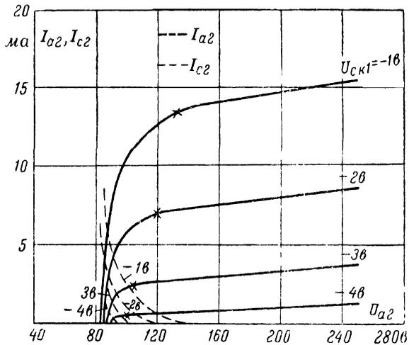
Рис. 12. Экспериментально снятые статические характеристики каскодного усилителя на лампе 6Н14П.
