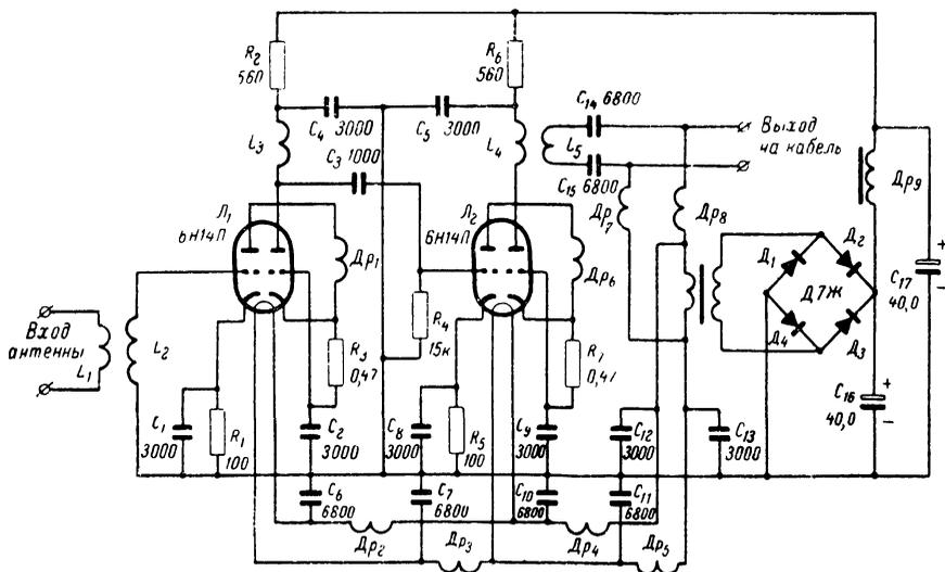
Рис. 23. Схема каскодного усилителя для антенной приставки.
