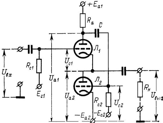
Рис. 49. Основная схема каскодного катодного повторителя.
