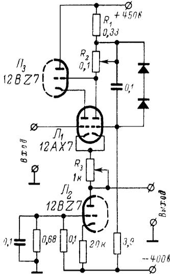
Рис. 78. Схема повторителя с дополнительной компенсацией.
