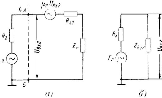
Рис. 4. Усилитель с заземленной сеткой.
