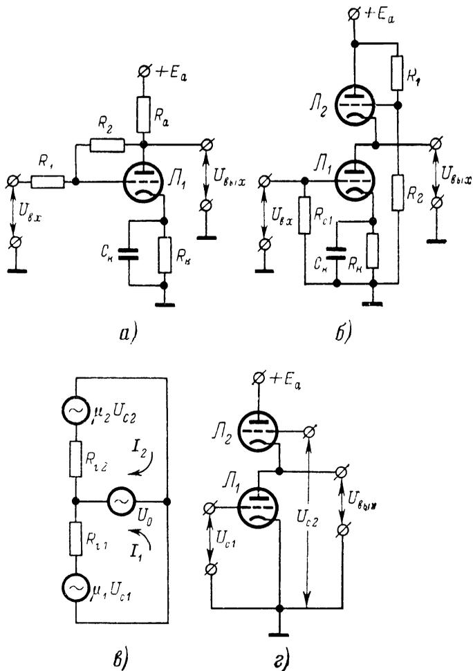
Рис. 37. Видоизменения основной схемы каскодного усилителя.
