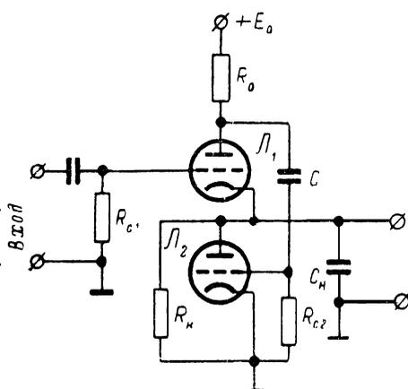
Рис. 61. Схема импульсного каскодного повторителя.
