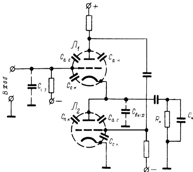
Рис. 56. Паразитные емкости в схеме каскодного катодного повторителя.
