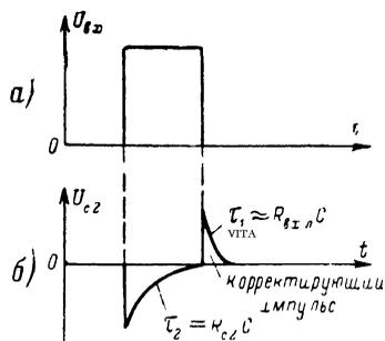
Рис. 63. Идеальный входной импульс (а) и соответствующие ему корректирующие импульсы после дифференцирующей цепочки (б).
