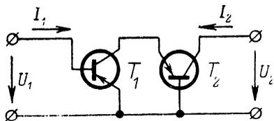
Рис. 16. Упрощенная схема транзисторного каскодного усилителя.
