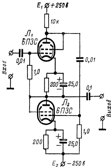
Рис. 65. Практическая схема импульсного каскодного катодного повторителя.
