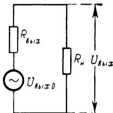
Рис. 51. Упрощенная эквивалентная схема каскодного катодного повторителя.
