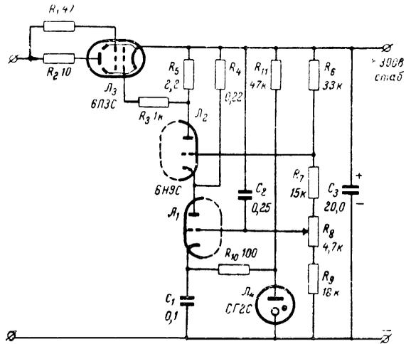
Рис. 28. Электронный стабилизатор напряжения с каскодным управляющим усилителем
