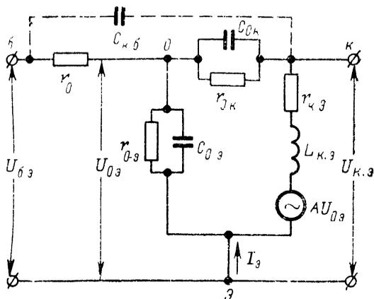
Рис. 18. П-образная моделирующая схема транзистора.
