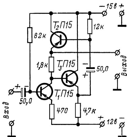
Рис. 44. Схема усилителя с динамической коллекторной нагрузкой.
