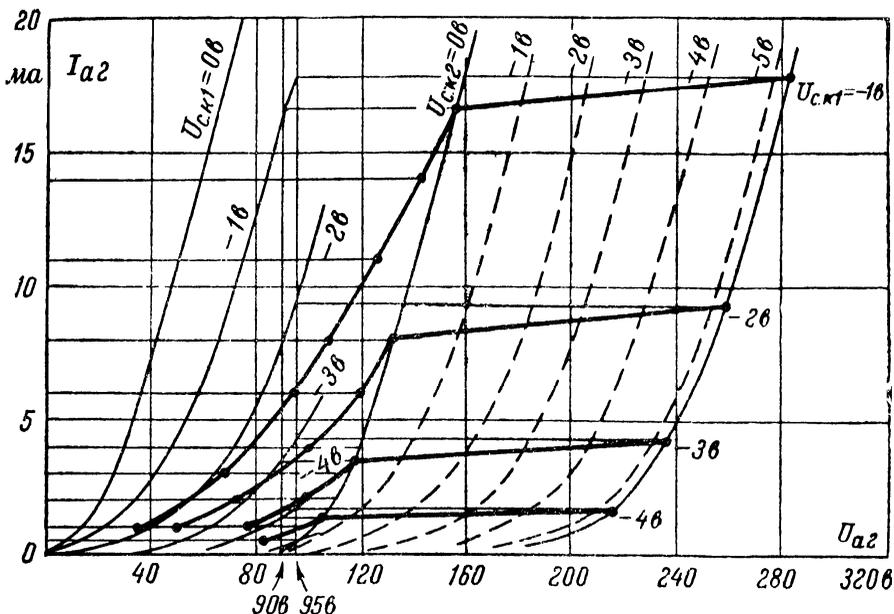
Рис. 10. Статические характеристики каскадного усилителя на лампе 6Н14П, построенные графически.
