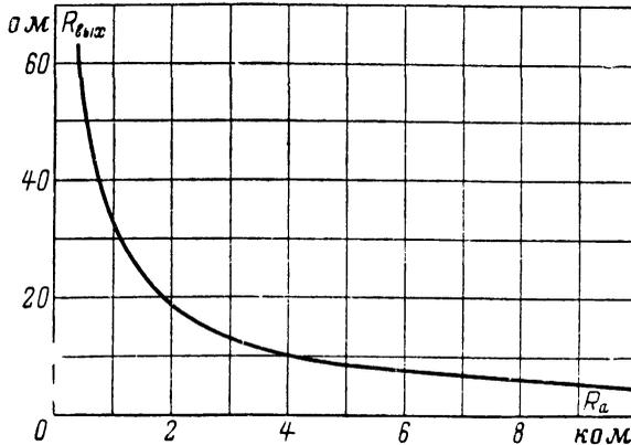
Рис. 52. Зависимость выходного сопротивления каскового катодного повторителя от величины положительной обратной связи для пентодов 6Ж1П с крутизной  $S=5$  ма/в.
