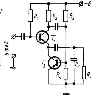
Рис. 69. Схема каскодного эмиттерного повторителя.
