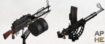
2 x Пулеметы Parabellum (Носовая и хвостовая турели) 1 x Автоматическая пушка Becker (Хвостовая турель)
