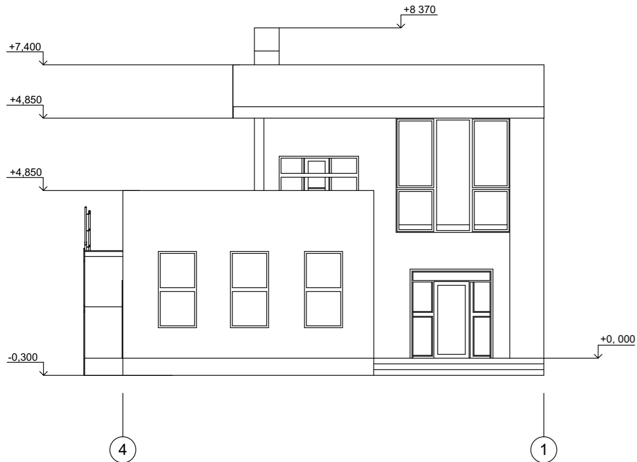
Фасад в осях 1-4 М1:100
