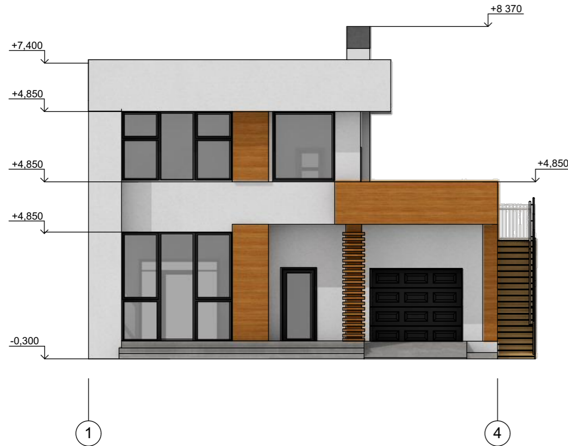
Фасад в осях 1-4 М1:100
